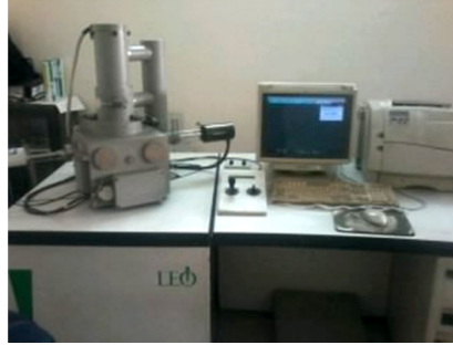
Fig. 4 SEM set up
